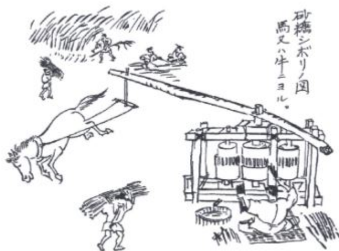
第1図 名越左源太『南島雑話』の水平三転子一列配置型任搾機
